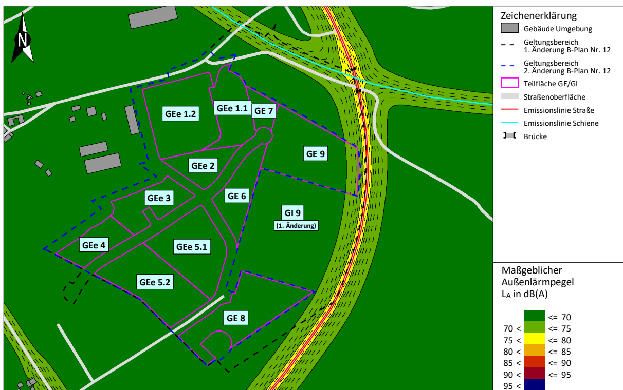
Abbildung 15 Isophonenkarte in 8 m Höhe über Gelände | Maßgeblicher Außenlärmpegel gemäß DIN 4109 | Büroräume u. Ä.
